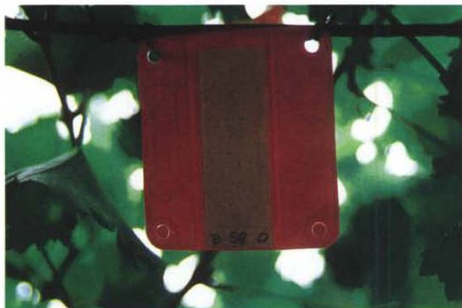
Un problema specifico risolvibile con l'analisi dell'immagine è la valutazione della qualità di distribuzione delle macchine per i trattamenti di colture attraverso l'analisi delle cartine idrosensibili analizzate al microscopio e l'acquisizione dell'immagine dell'area irrorata mediante videocamera.
